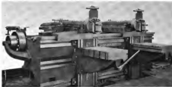
Fig. 3. Shapingmaschine mit Bewegung des Stöpsels durch Schraubenspindel. 1000 mm Hub.
